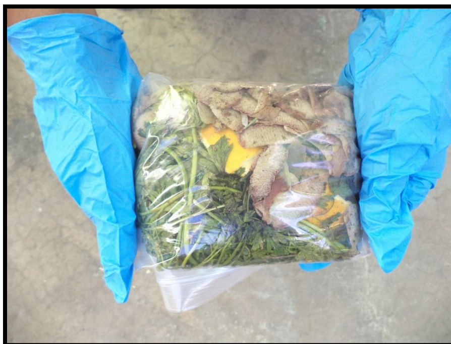
Ilustración 21: Extracción de muestra para el parámetro de humedad.
