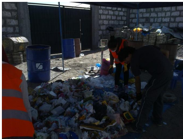
Fig. N° 5. Homogenización de residuos sólidos con ayuda de palas
