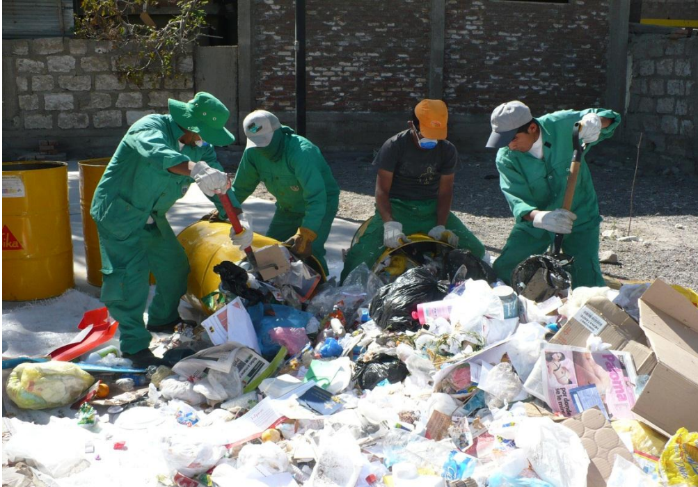
Fotografía 7: llenado de los cilindros para determinar el peso y su densidad.
