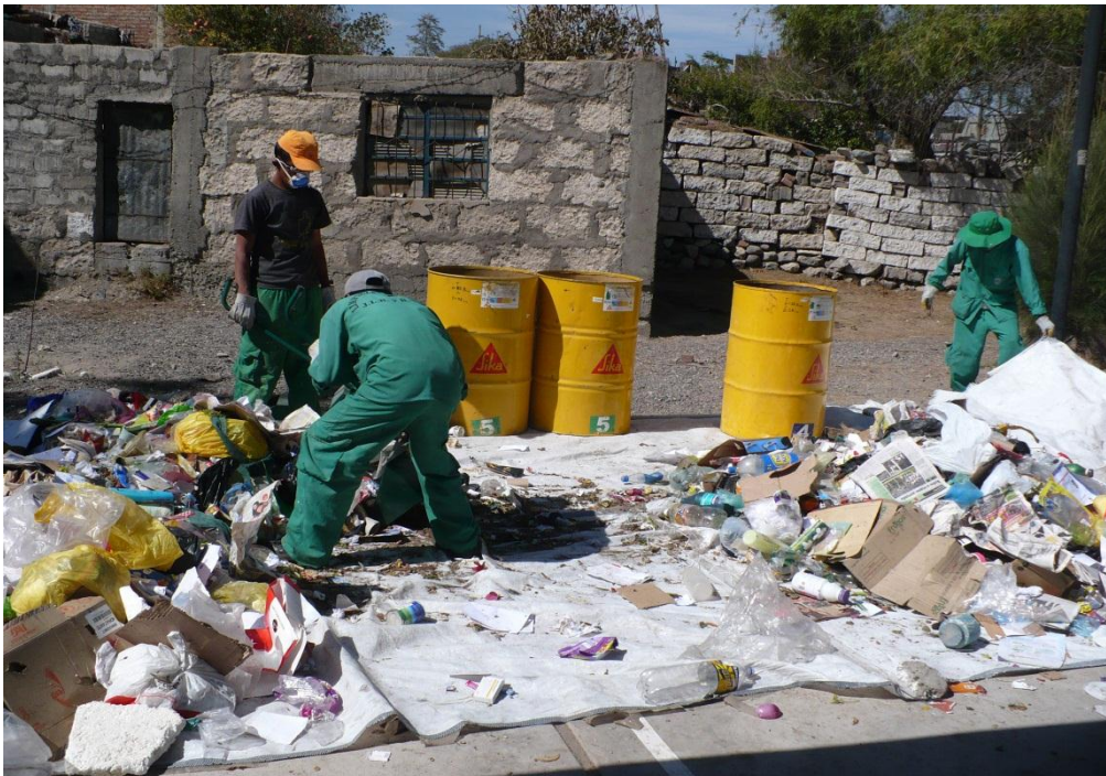
Fotografía 7: llenado de los cilindros para determinar el peso y su densidad.
