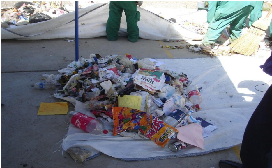
Fotografía 9: Muestra final obtenida del método del cuarteo.
